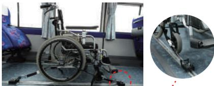
多種多様な車椅子に対応できるようレール式の4支点止めで固定します。
